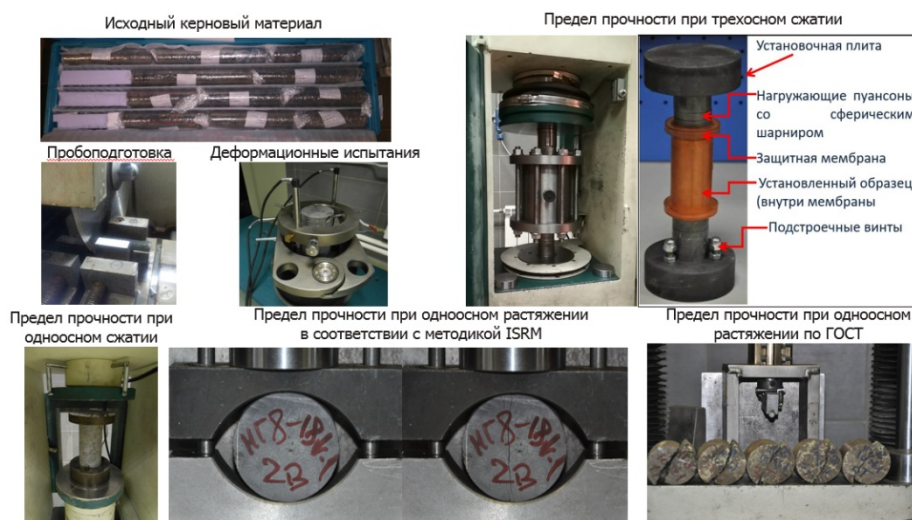
Рисунок 6 – Проведение физико-механических испытаний образцов
