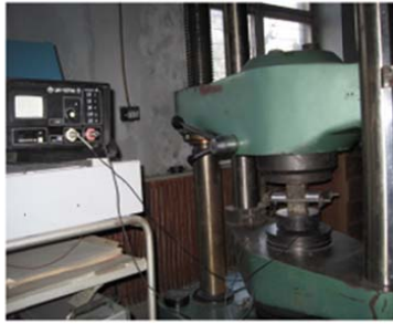
Нагружение и прозвучание призматического образца
