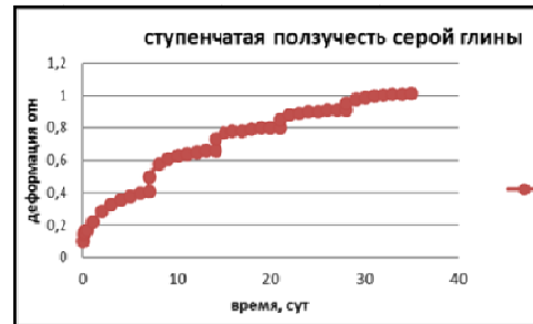
Кривые ступенчатой ползучести серой глины при постоянных сдвигающих напряжениях от 0,02МПа до 0,10 Мпа
