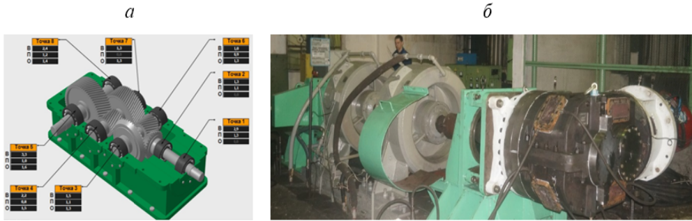
Рисунок 5 – Вибрационный паспорт редуктора (а) и общий вид обкаточного стенда (б)
